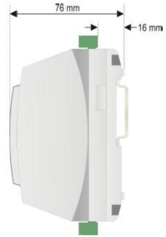
Rys. 3.5) Wymiary rejestratora – widok z boku.
